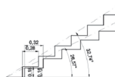
Figura 25- Escadas - ábaco. Fonte: ABNT NBR 9050: 2004
