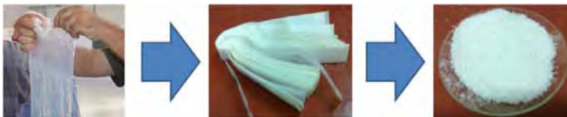
Figura 28. Obtenção das amostras de CB seca e triturada, preparadas a partir do hidrogel fornecido pela empresa Fibrocel® Produtos Tecnológicos.
