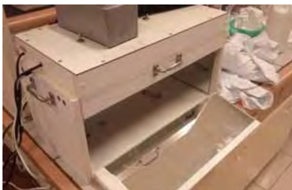
Figura 101. Box de madeira contendo lâmpada "luz negra" UV de 250W.
