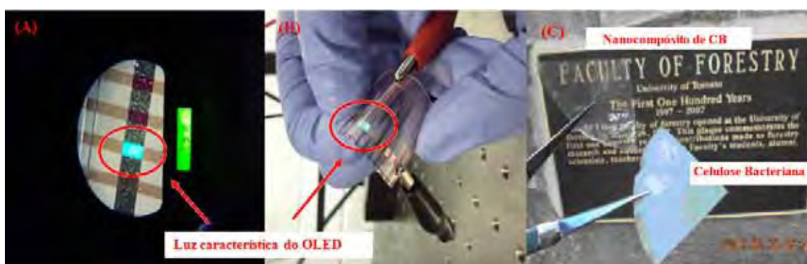
Figura 21. (A) e (B) Dispositivo OLED fabricado no substrato do nanocompósito de celulose bacteriana (C) Transparência óptica da CB e do nanocompósito CB/PU.
