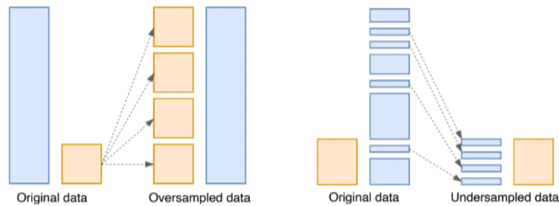
Figura 12 – Sobreamostragem (esquerda) e subamostragem (direita)
