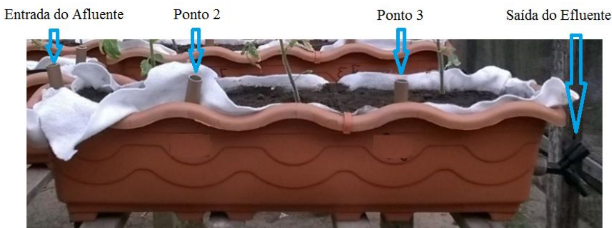
Figura 10. Pontos de coleta de amostras, entrada do afluente e saída do efluente tratado.
