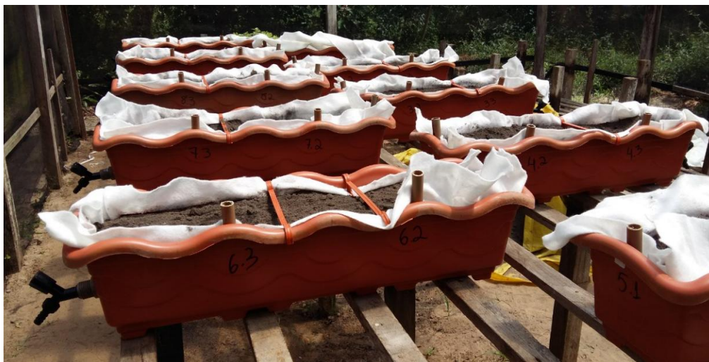
Figura 15. Tratamentos Anaeróbios Horizontais de Fertirrigação Subsuperficial (TAHFS).
