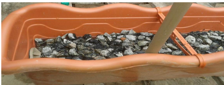
Figura 8. Leito do RAHLF com meio suporte Brita inoculado em lodo anaeróbio.
