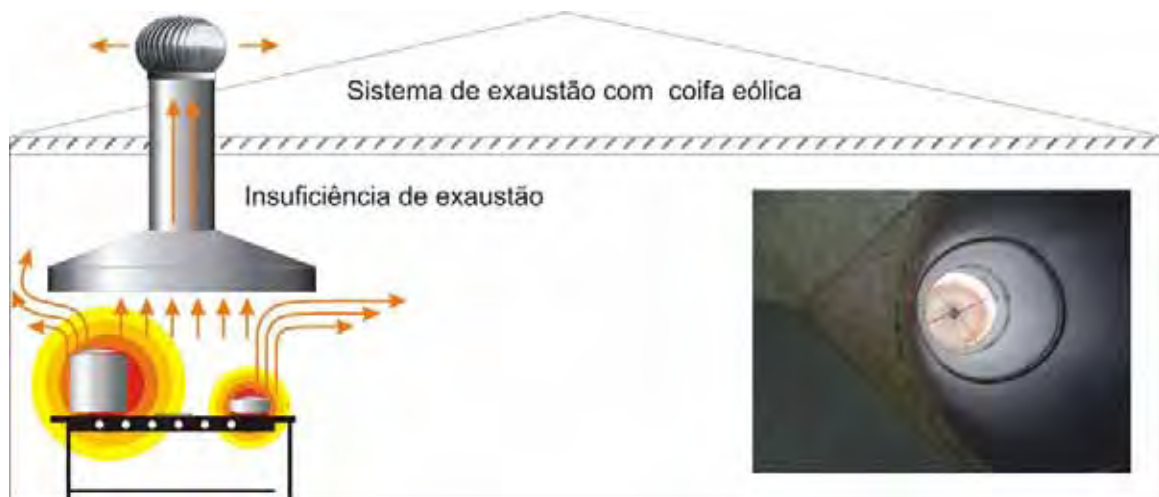
Figura 11. Sistema ineficiente de troca de ar
