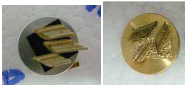
Figura 5: Amostras montadas em “stubs” (a esquerda) e cobertos com ouro (a direita)
