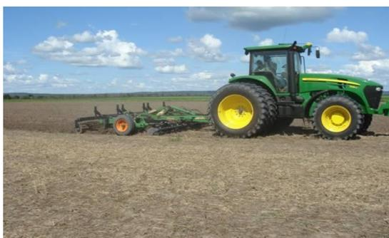
Figura 2. Conjunto Trator Subsolador utilizado no preparo de solo.
