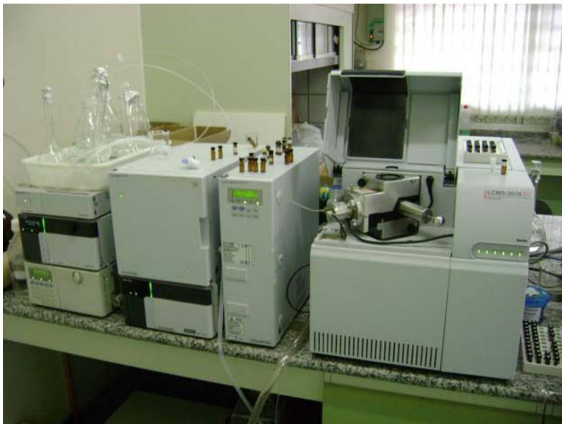
Figura 5. Cromatógrafo Líquido de Alta eficiência e espectrômetro de massas (LC/MS) utilizado na determinação da azoxistrobina. Botucatu/SP - 2013. (Foto Carbonari, 2009).
