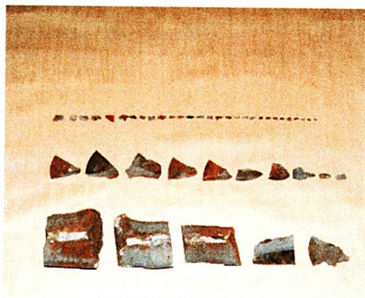
FIGURA 7.4 - Bloco fragmentado pela detonação de uma carga com 35g de emulsão explosiva
