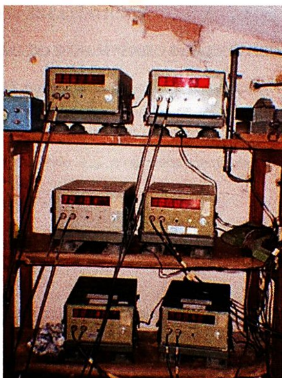
FIGURA 5.14 - Cronômetros digitais CRM 1038 fabricados pela Fábrica de Material de Comunicações e Eletrônica da IMBEL
