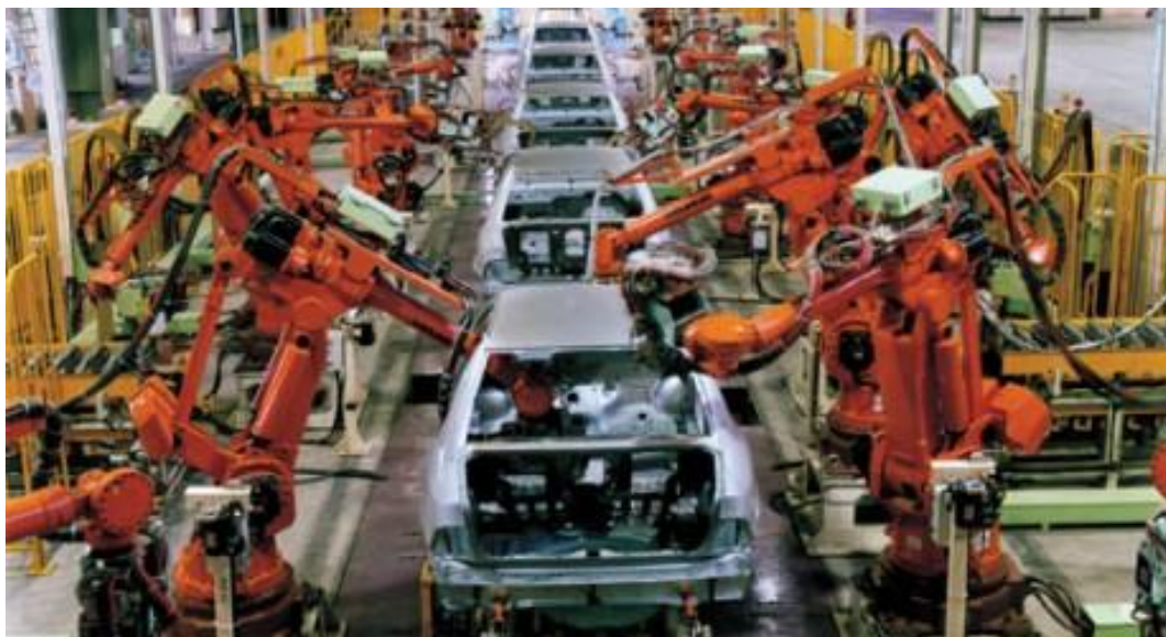
Figura 12 – Automação em montadora de automóveis através de braços robóticos.
