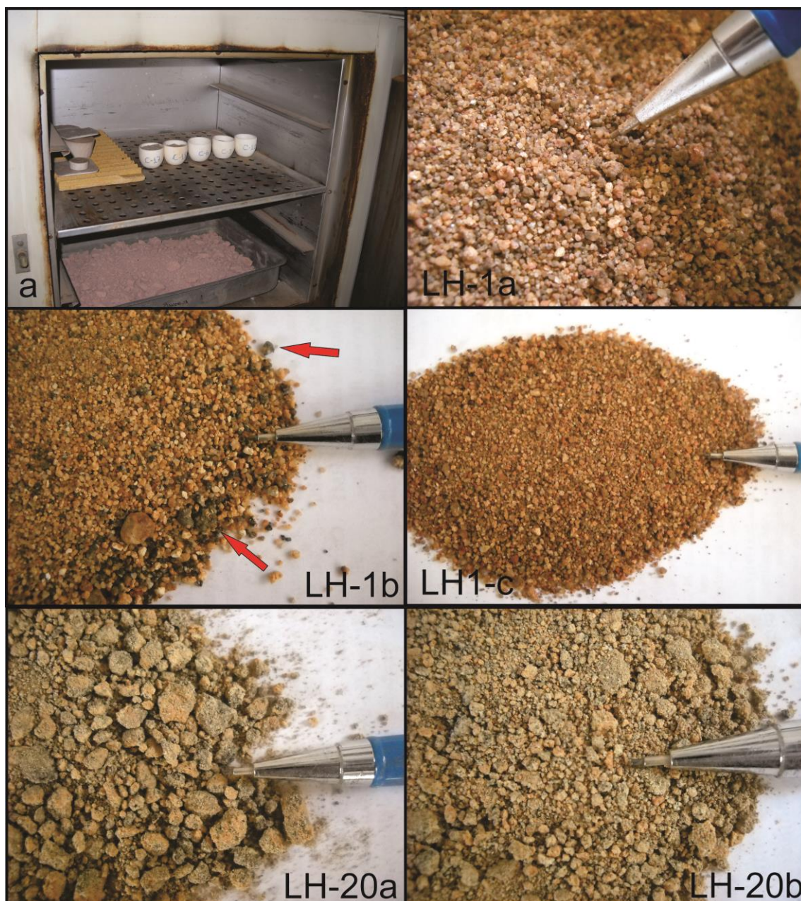
Figura 38: a: Foto apresentada as cinco amostras dentro da estufa após a calcinação. LH-1a: Os grãos apresentam-se com coloração levemente avermelhada e aparentemente mais “limpos”, sem o material negro impregnado. LH-1b: os grãos apresentam-se com coloração levemente avermelhada, mas grande parte dos grãos negros não sofreu alteração, como indicado nas setas vermelhas. LH-1c: Os grãos apresentam-se com coloração levemente avermelhada e aparentemente mais “limpos”, sem o matéria negro impregnado. LH-20a: Os grãos apresentam-se com coloração mais clara em relação à antes do processo, sem o material negro impregnado. LH-20b: Os grãos apresentam-se com coloração mais clara em relação à antes do processo, sem o material negro impregnado.
