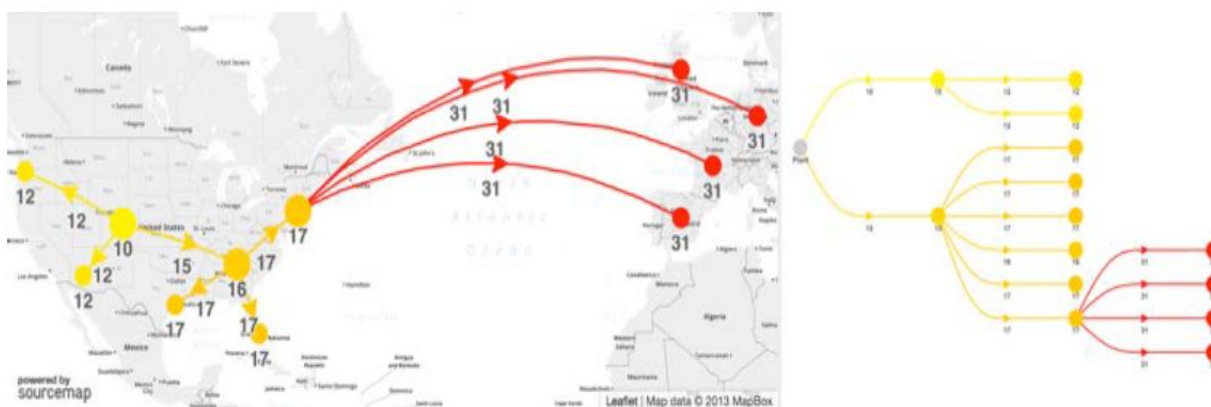
Figura 12 – Um exemplo de visualização da cadeia de suprimentos de ponta a ponta para otimização: prazos de entrega em dias sobrepostos em um mapa da cadeia de suprimentos (esquerda) e modelo de rede (direita).
