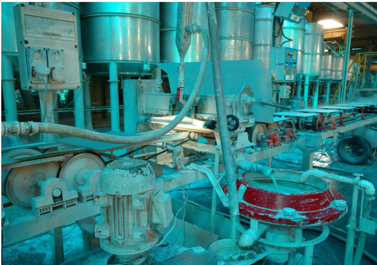
**Figura 3 – Aplicação de engobe no revestimento**
