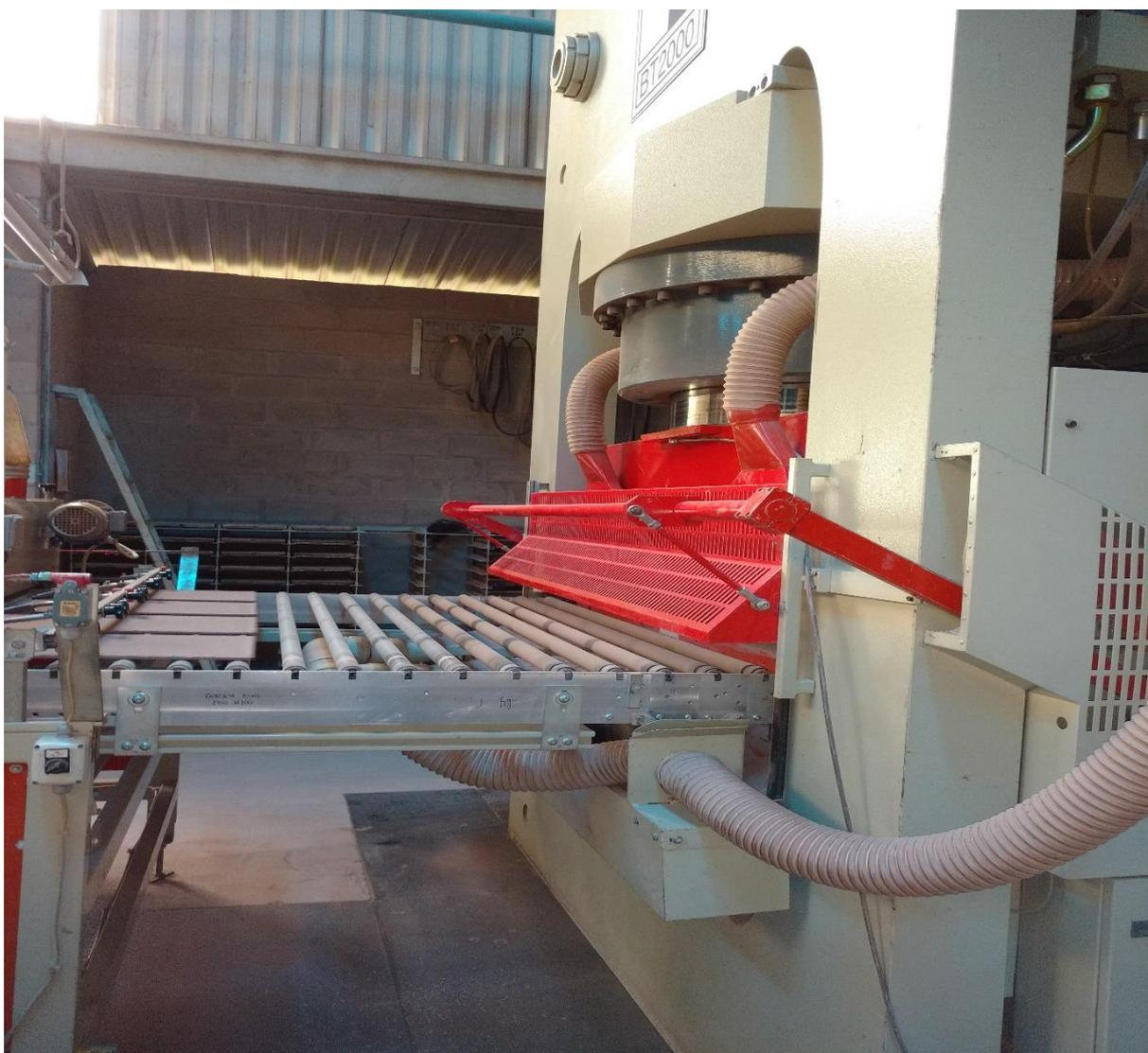
**Figura 1 – Prensa para moldagem do revestimento cerâmico**
