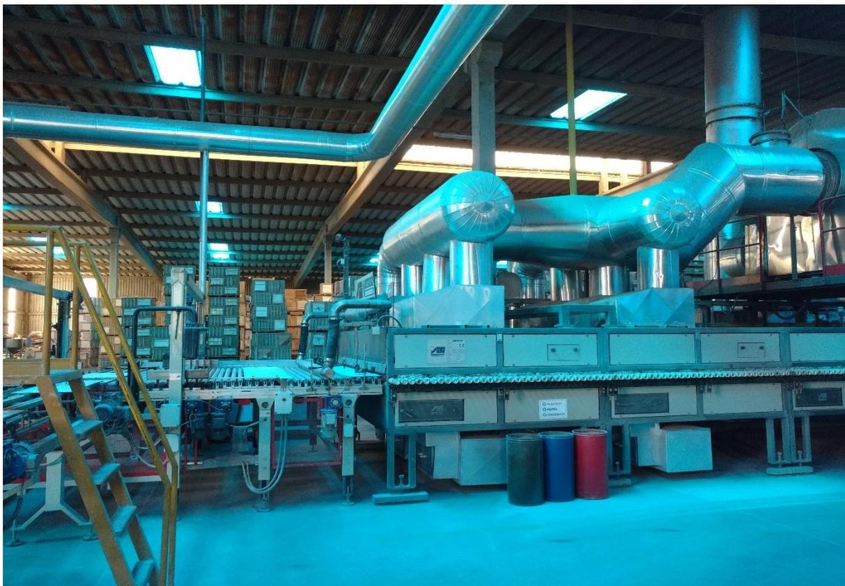
**Figura 4 – Forno horizontal para secagem dos revestimentos cerâmicos**
