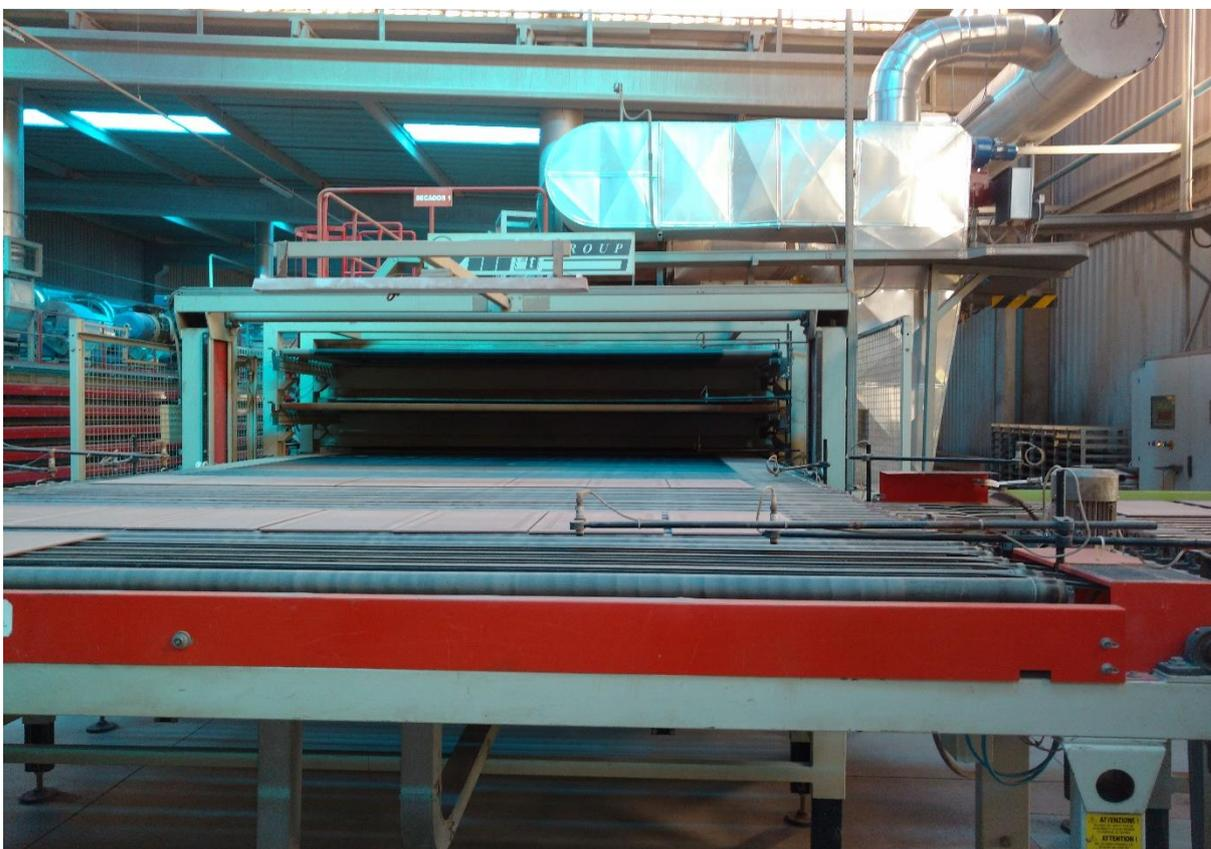
**Figura 2 – Secador para retirar o excesso de umidade**
