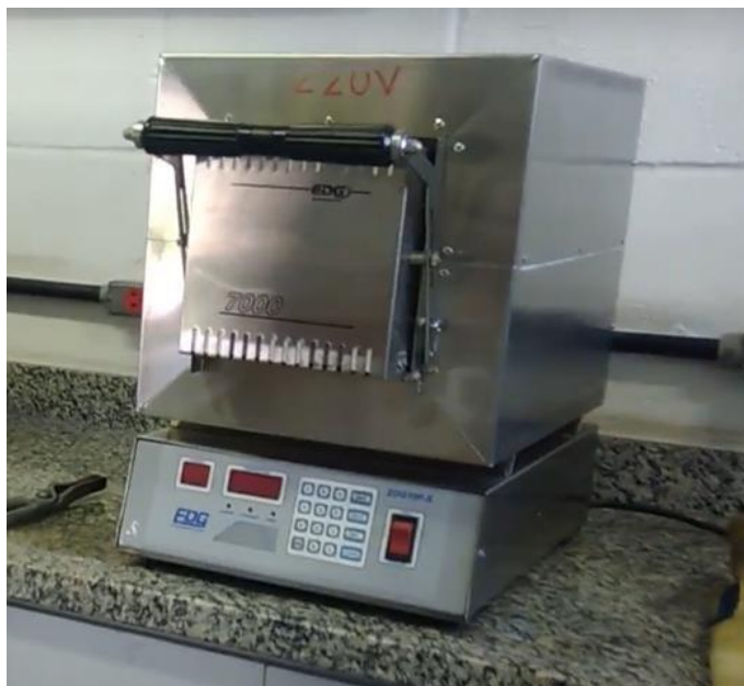
Figura 12 – Forno tipo mufla utilizado na re-impregnação
