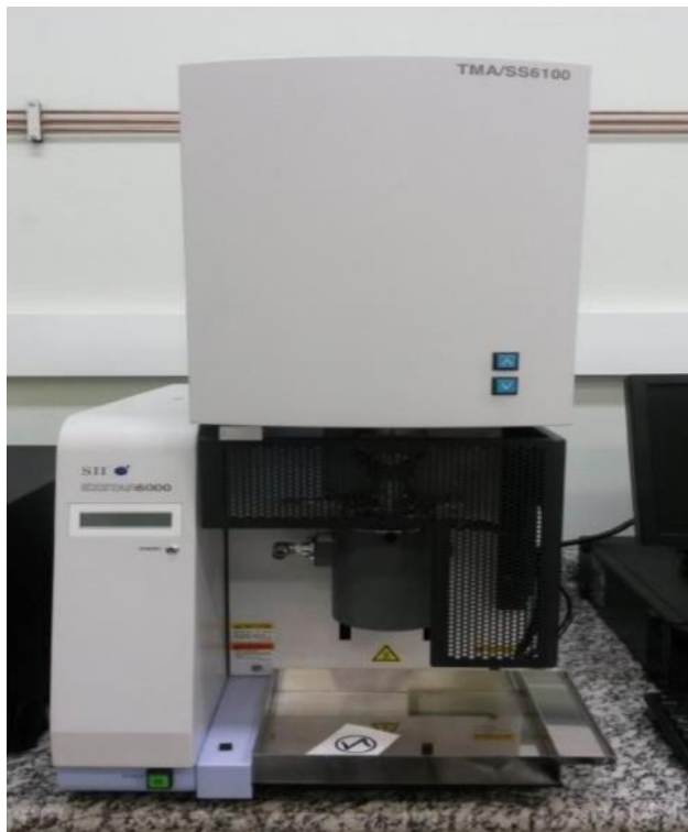
Figura 13 – Equipamento SEIKO TMA/SS 6100
