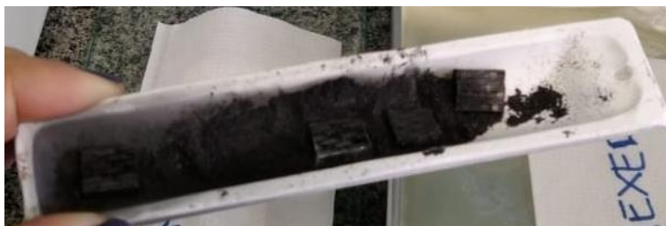
Figura 10 – Amostras no material refratário
