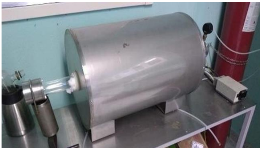
Figura 11 - Forno tubular utilizado para a carbonização.
