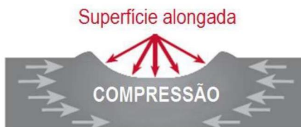
Figura 10 – Camada uniforme de tensões residuais compressivas gerada abaixo das concavidades criadas pelo impacto das granalhas
