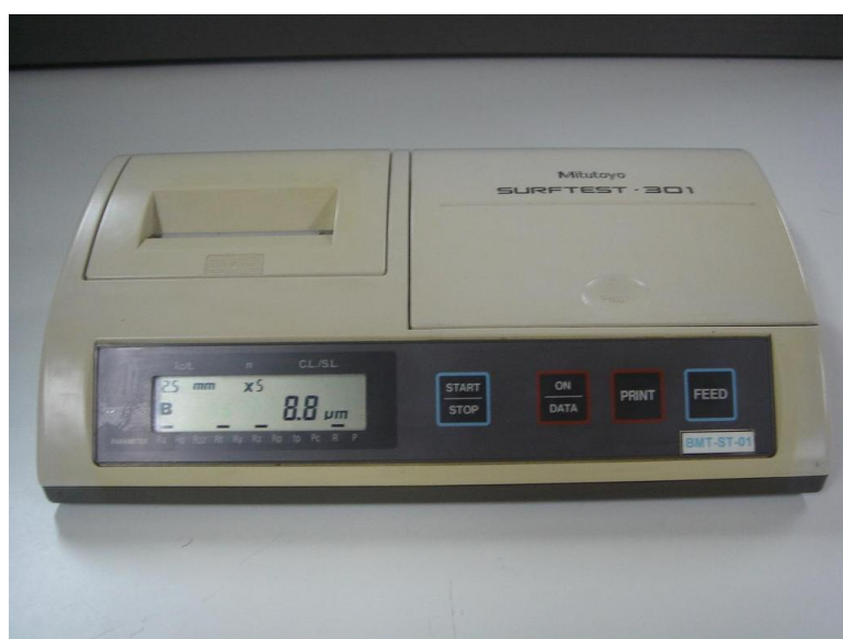
Figura 22 – Rugosímetro portátil Surftest 301.
