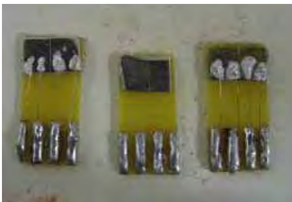
FIGURA 30: Montagem da Junção no substrato de prata e Aluminato, onde se deposita o óxido de alumínio como isolante. Com 0.2 mm de largura e 240nm de espessura.
