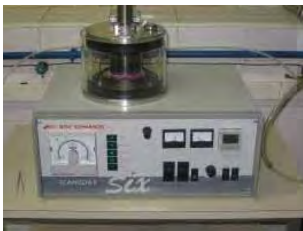
FIGURA 31: Imagem do equipamento de deposição por Sputtering , usado para a deposição da prata nas amostras.
