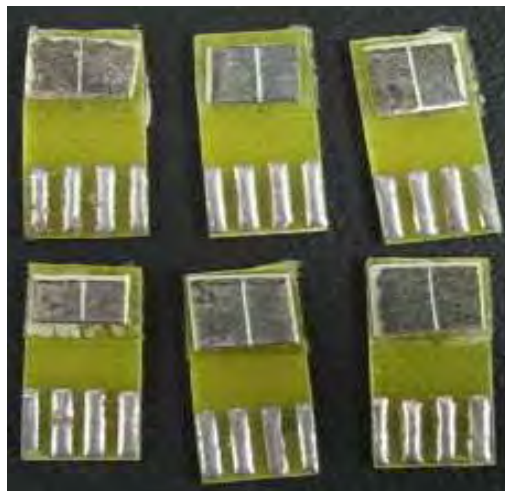
FIGURA 29: Imagem de como foi montada a junção. Percebemos no meio o canal fino (aproximadamente 0.2 mm de largura) realizado para a deposição do isolante - óxido ou do metal-prata.
