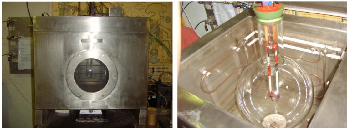
Figura 31 - Câmara de aquecimento
