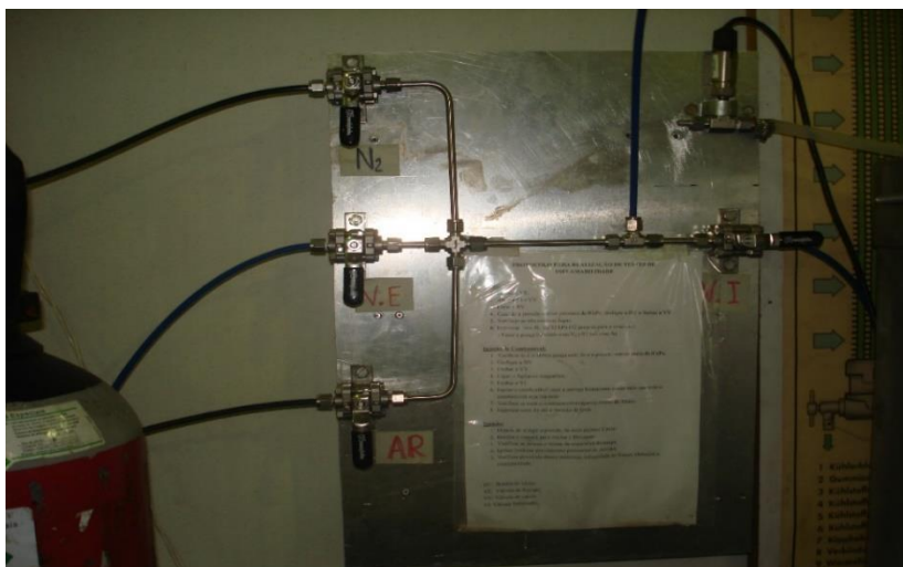
Figura 36 - Tubulações e válvulas para levar o nitrogênio e ar sintético para câmara de combustão
