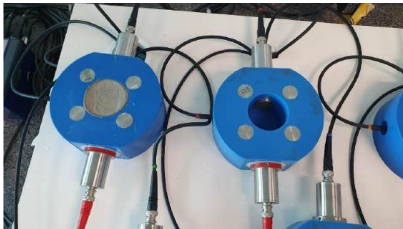
Figura 16: Equipamento utilizado para medir a velocidade do ultrassom na amostra
