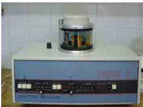
5. Aparelho utilizado na metalização prévia dos espécimes antes da leitura no Microscópio Eletrônico de Varredura.
