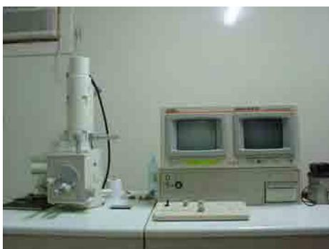
6. Microscópio Eletrônico de Varredura da FCAV - UNESP. Campus Jaboticabal
