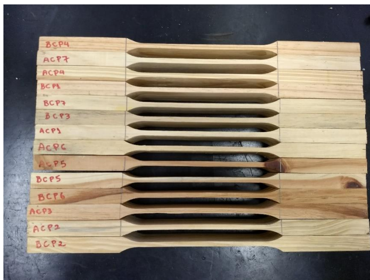
Figura 3: Confeção de corpos de prova tração paralela às fibras (I).
