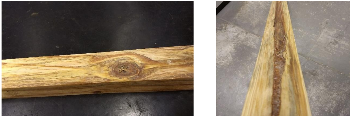
Figura 16: Defeitos visuais nos corpos de prova 19.
