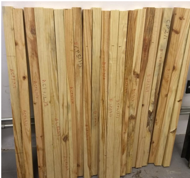
Figura 5: Confeção de corpos de prova para flexão estática (II).
