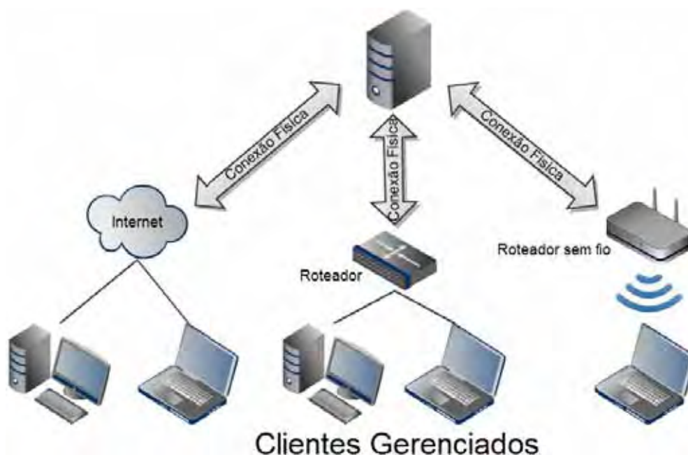
Figura 14 - Arquitetura de rede de computadores utilizando um servidor de gerenciamento e clientes gerenciados na rede.
