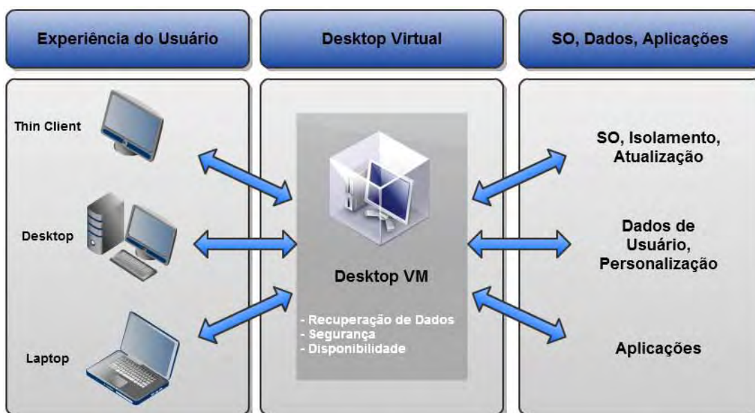
Figura 16 - Diagrama do WSE-OS. Adaptado de (VMWARE, 2011c).
