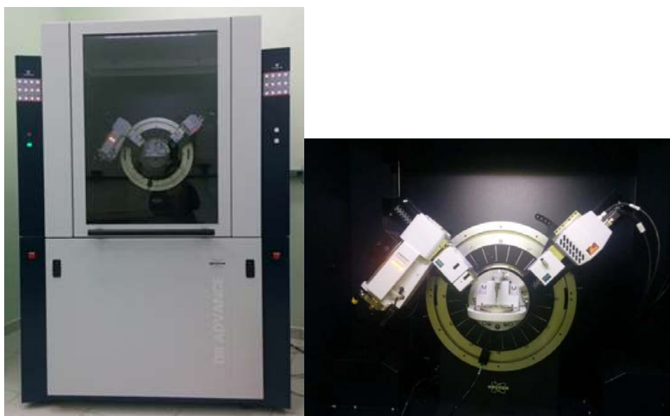
Figura 13. Difratrômetro Bruker D8 Advance ECO.
