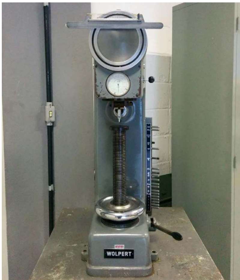
Figura 12. Durômetro Otto-Wolpert-Weke Dia Testor 2Rc G.m.b.H LUDWIGSHAFEN a. RH.
