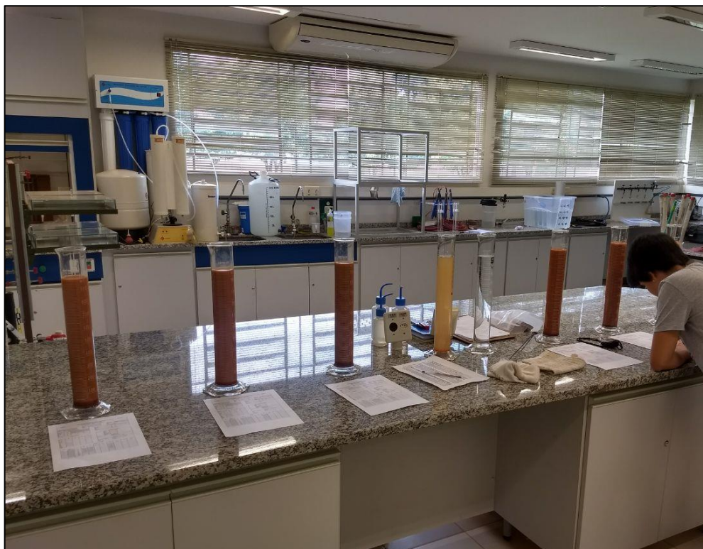
Figura 10: Ensaio de granulometria conjunta realizado no RAIH. Foto tirada por Gabriel Cardoso Leite.
