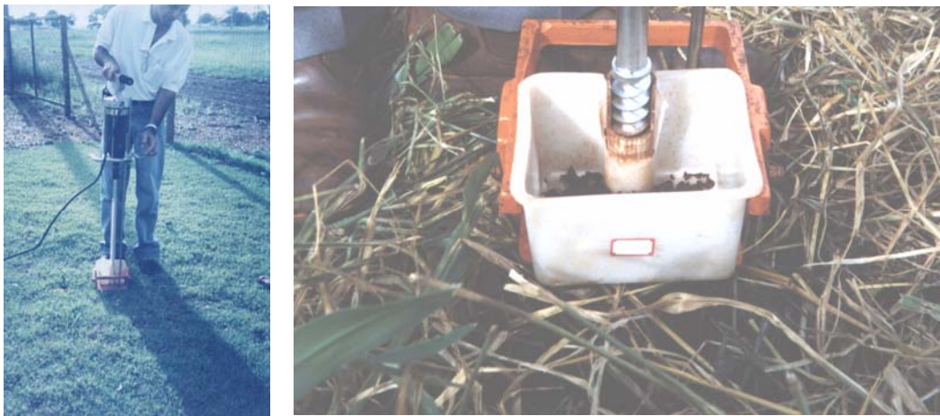
Figura 2. Coleta de amostras com trado mecânico (precisão na profundidade e volume).
