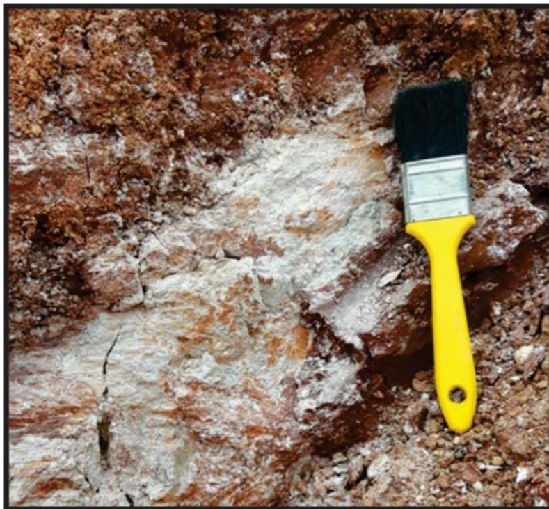
Figura 13: Alteração intempérica no metadolomito com a formação de argilominerais e presença de talcificação incipiente.
