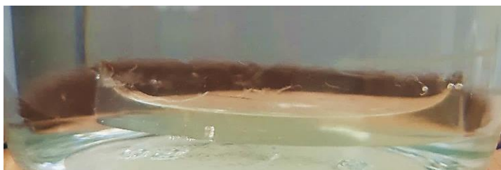
Figura 8 Membrana híbrida ativada com nanopartículas de MOF incorporadas, submersa em meio PBS
