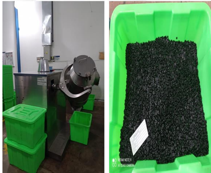
Figura 10 - Processo de Siliconização do Pistão
