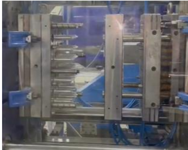
Figura 18 - Molde Utilizado na Produção dos Cilindros
