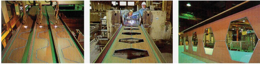
Figura 2. Processo de fabricação de vigas alveolares
