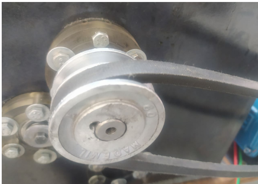
Figura 17 - Polia montada no eixo da engrenagem menor
