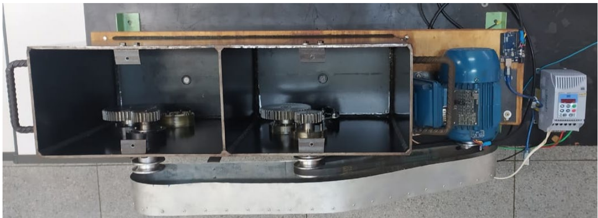
Figura 14 - Imagem do motor elétrico e do acionamento por polias e correia para movimentar as engrenagens
