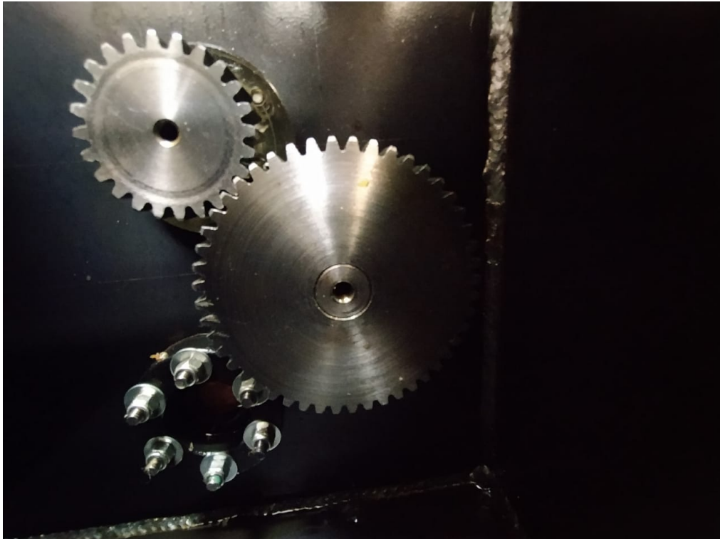
Figura 15 - Imagem das engrenagens montadas na caixa redutora
