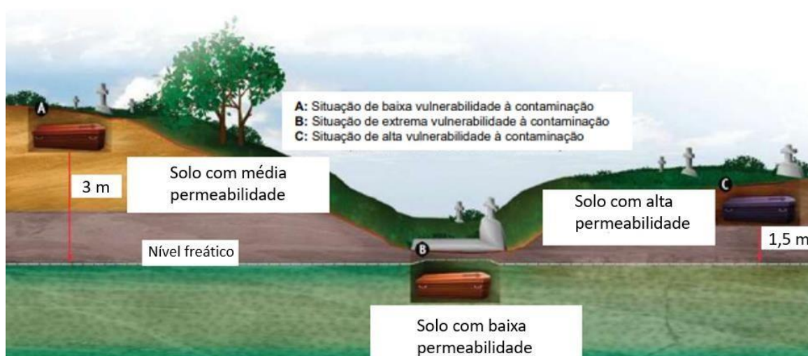
Figura 1 – Situações de vulnerabilidade, tendo em vista a permeabilidade do solo (Fonte: modificado de Silva, Malagutti Filho (2009)).
