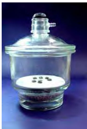
FIGURAS 12 e 13- Dessecador a vácuo e amostra metalizada, respectivamente.
