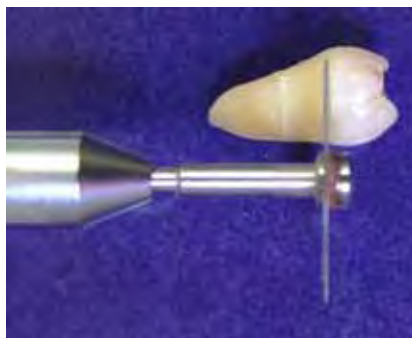
FIGURAS 4 e 5 - Disco diamantado em baixa rotação e obtenção das duas amostras, respectivamente.
