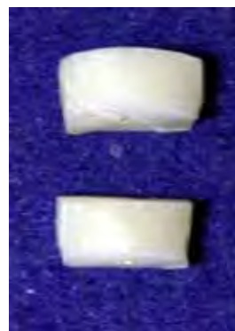
FIGURAS 4 e 5 - Disco diamantado em baixa rotação e obtenção das duas amostras, respectivamente.
