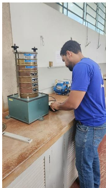
Figura 11 - Conjunto de peneiras utilizadas para realização do ensaio para determinação da composição granulométrica
