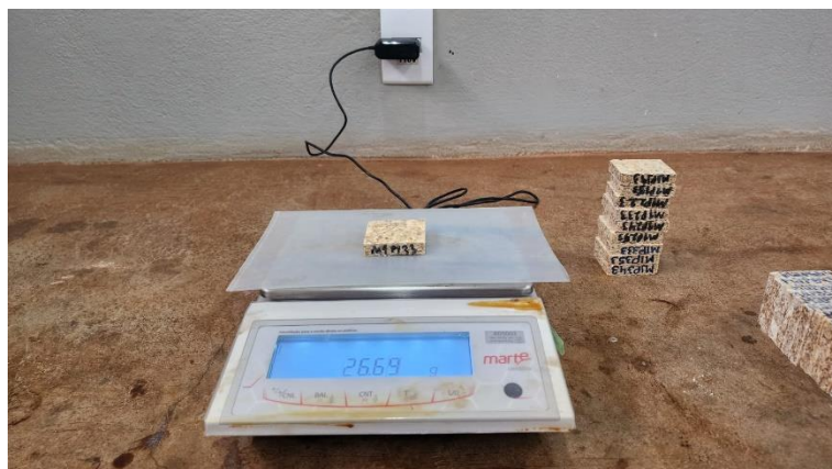
Figura 18 - Aferição da massa dos corpos de prova para cálculo da densidade
