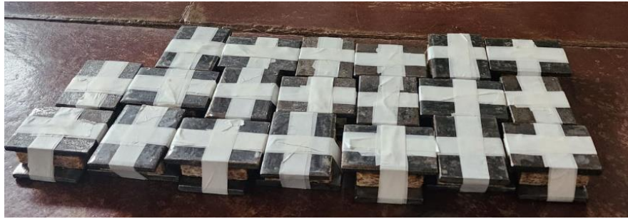
Figura 21 - Realização dos corpos de prova para realização do teste de resistência à tração perpendicular
