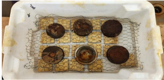
Figura 19 - Realização do teste de inchamento da espessura após vinte e quatro horas
