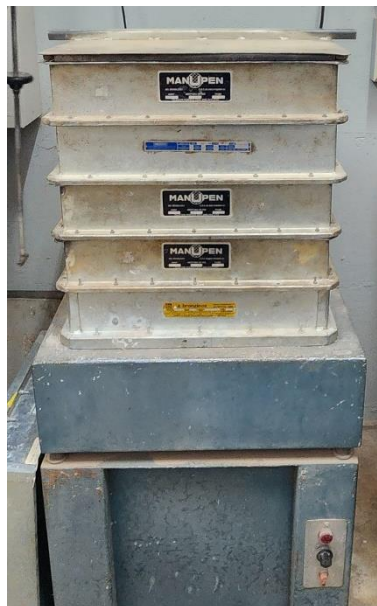
Figura 10 - Classificação granulométrica em um agitador elétrico de peneiras
