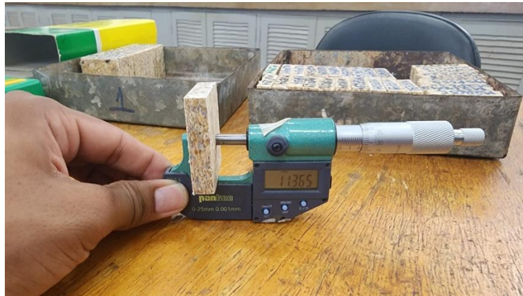
Figura 17 - Medição da densidade dos painéis, utilizando paquímetro e micrômetro
