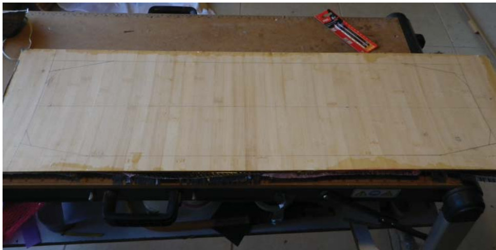
Figura 36- Marcação das linhas de corte na placa do lado de cima
