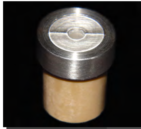
FIGURA 4 – Matriz utilizada para a aplicação da resina.
