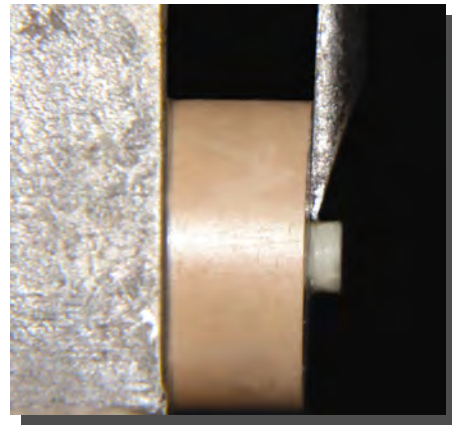
FIGURA 6 – Teste de resistência ao cisalhamento.
