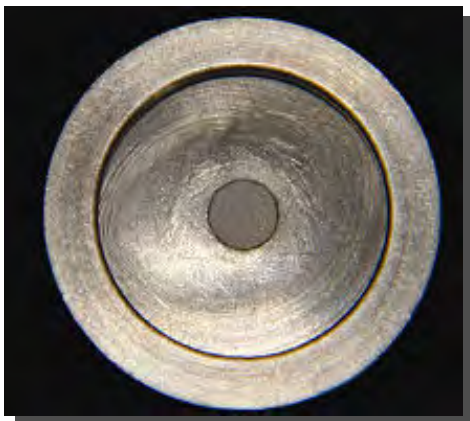
FIGURA 3 – Matriz utilizada para a aplicação do opaco.
