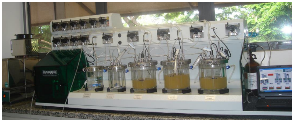
Figura 1. Imagem do Simulador computadorizado do Ecossistema Microbiano Humano (SEMH) sediado no Laboratório de Microbiologia de Alimentos da Faculdade de Ciências Farmacêuticas de Araraquara/UNESP.
