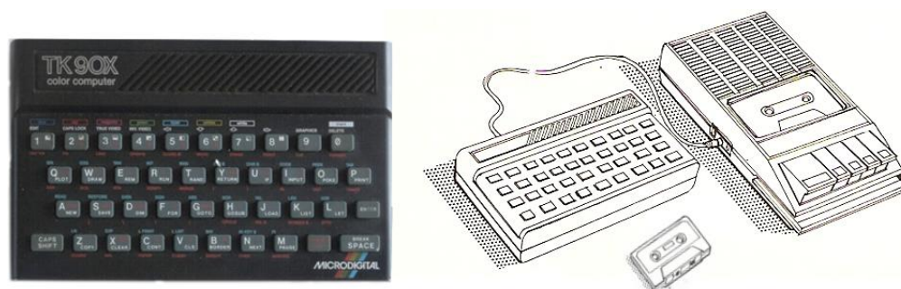
Figura 2: O aplicativo FUNÇÕES foi programado em uma unidade de processamento TK-90X com 48 Kbytes de memória que, acoplada a uma televisão, utilizava como unidade de leitura um gravador de fita cassete. Na imagem, uma fotografia do computador utilizado nas minhas experiências e um dos muitos esquemas pictóricos contidos em seu manual de operação. (TK-90X, 1985 p.I-16)
