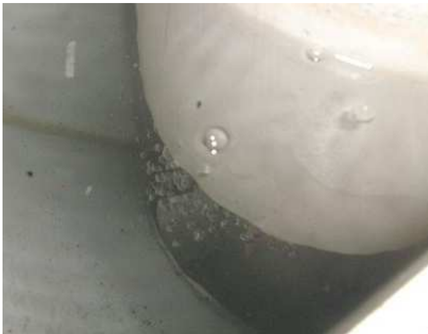
Figura 6.12: Registro do momento em que parte das bolhas é transportada para o tubo externo
