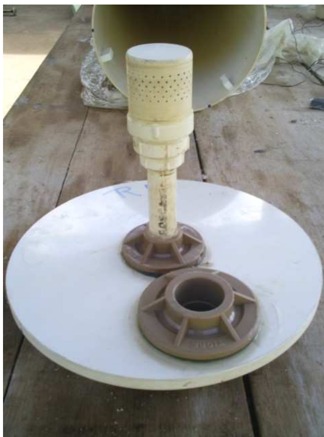
Figura 5.3: Detalhe do injetor de ar e do fundo do reator
