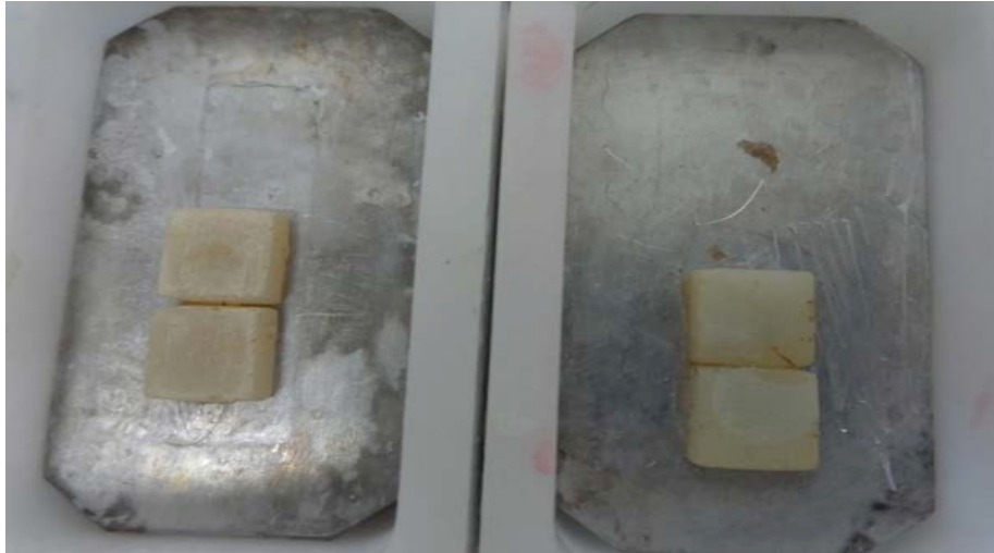
Figura 23 - CP fixados na superfície metálica para o teste de escovação
