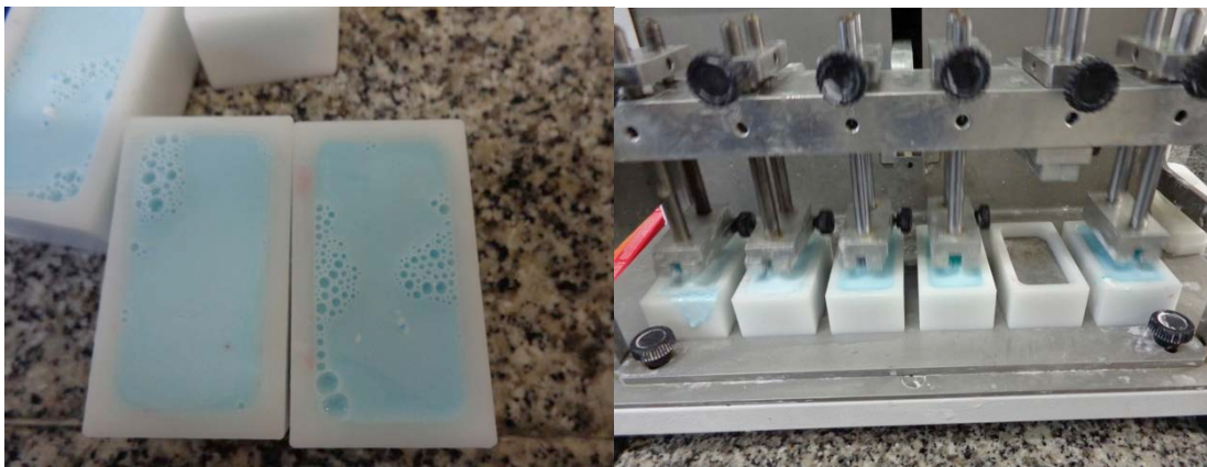
Figura 26 - Teste de escovação simulada
