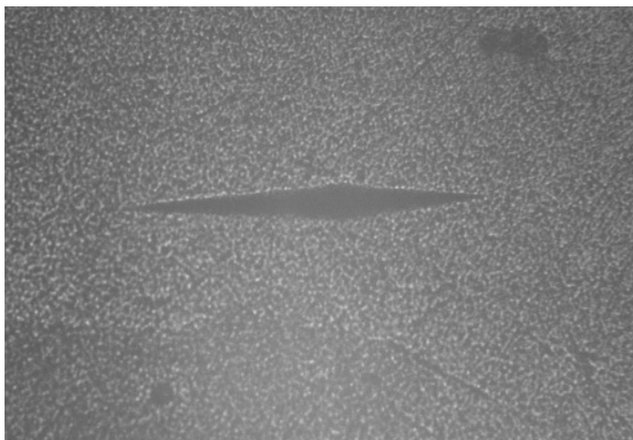
Figura 35- Impressão registrada em 40 X de aumento, realizada no teste de microdureza Knoop em uma amostra da resina composta Esthet-X TM HD do grupo teste.
