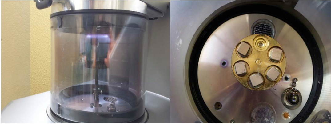
Figura 27- Aparelho Metalizador Quarum (Q150R ES) (conclusão)
