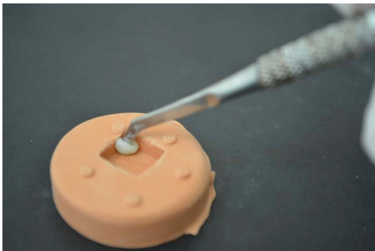
Figura 11 - Inserção das resinas compostas nanoparticuladas ( Esthet X-HD , Z350 , Grandio ) e a resina bulk fill ( X-tra fill ) no interior da matriz
