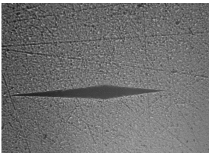
Figura 42 - Impressão registrada em 40 X de aumento, realizada no teste de microdureza Knoop em uma amostra da resina composta Z350 do grupo teste.
