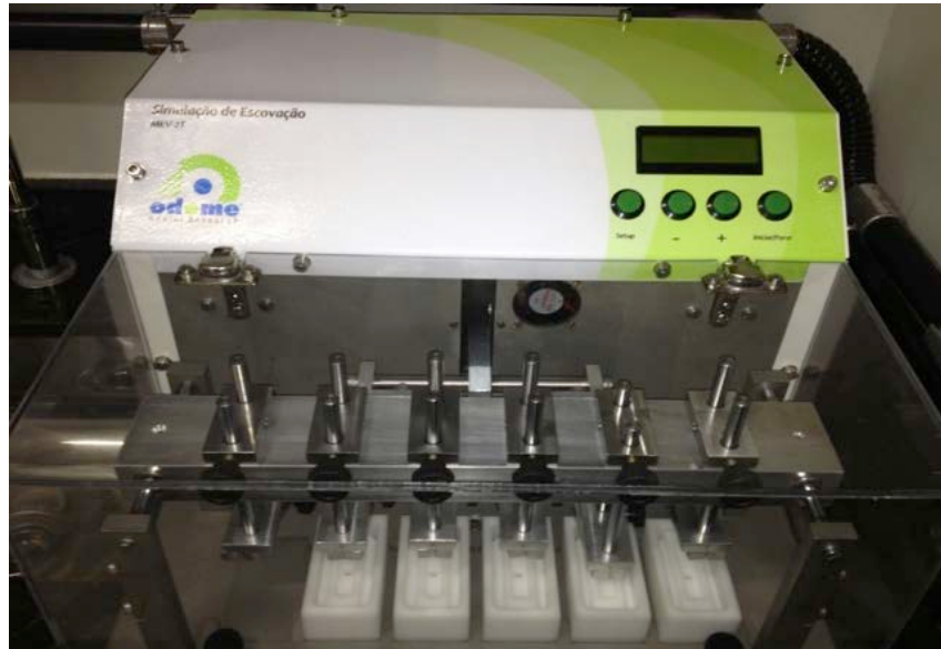
Figura 22 - Escova Oral B, fixada na máquina de escovação
