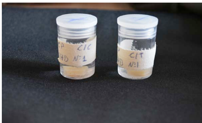
Figura 14- Corpos-de-prova após a polimerização, imersos em água destilada e armazenados em estufa por 24hs e 07 dias
