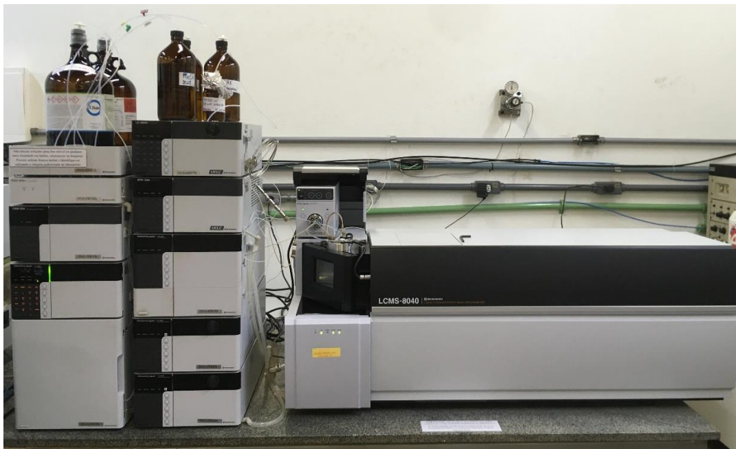
Figura 10. Cromatógrafo a líquido acoplado ao espectrômetro de massas modelo LCMS-8040 Shimadzu
