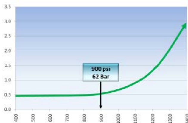
Figura 15 - Ponto onde a corrosão passa a ser crítica
