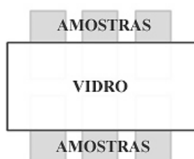
Figura 4.2 – Ilustração esquemática do posicionamento e proteção das 6 amostras de cada série para serem submetidas ao processo de ablação à plasma.
