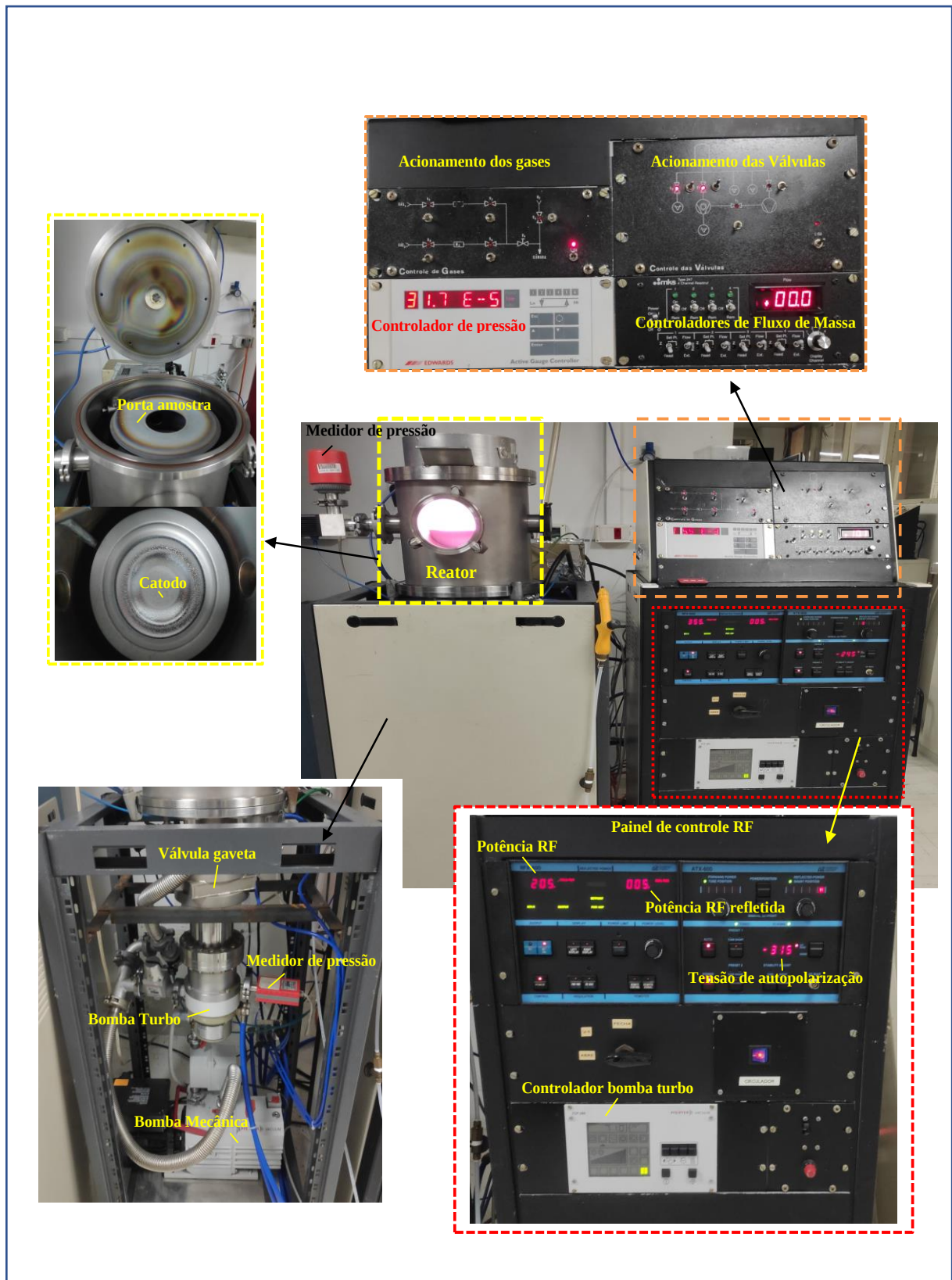
Figura 3.2.2 – Sistema RF Magnetron sputtering utilizado neste trabalho.
