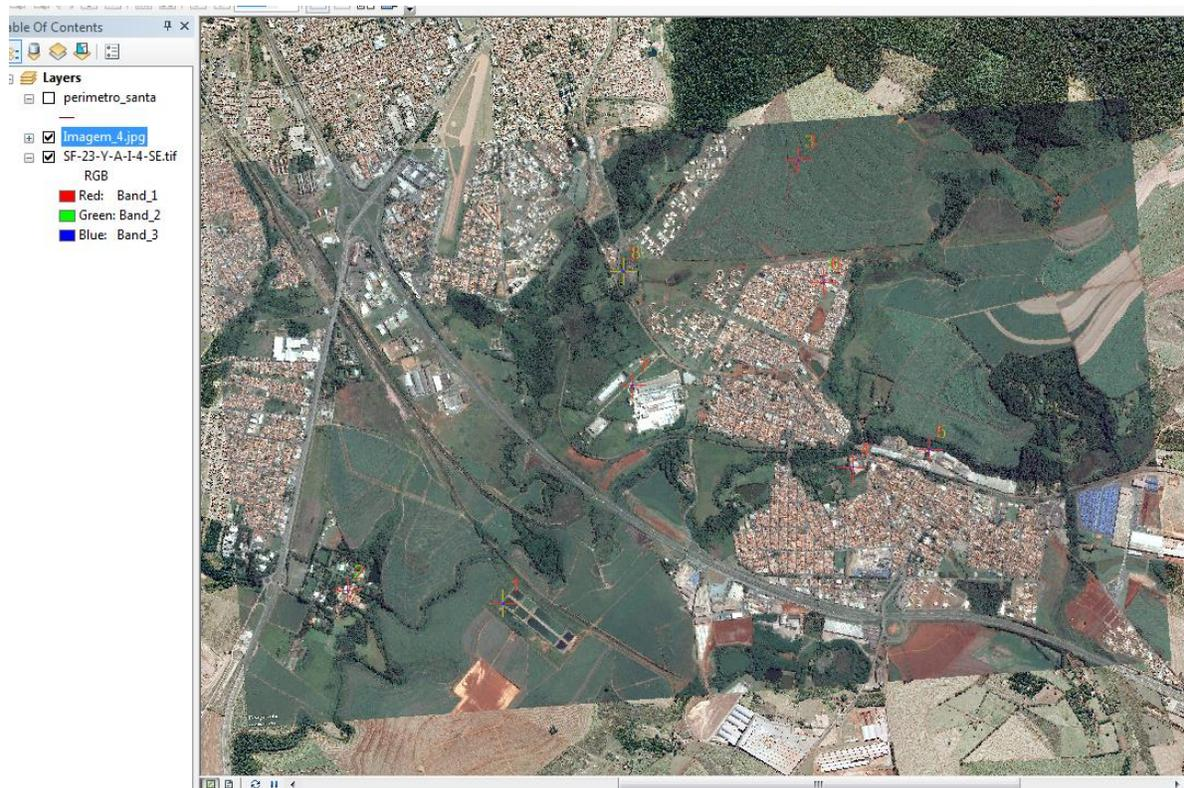
Desse modo, as duas fotografias aéreas analógicas de 1995 foram digitalizadas e transformadas em arquivos digitais. Posteriormente, realizou-se o georreferenciamento, selecionando-se 8 pontos de controle para a primeira imagem, e 7 pontos de controle para a segunda imagem.
