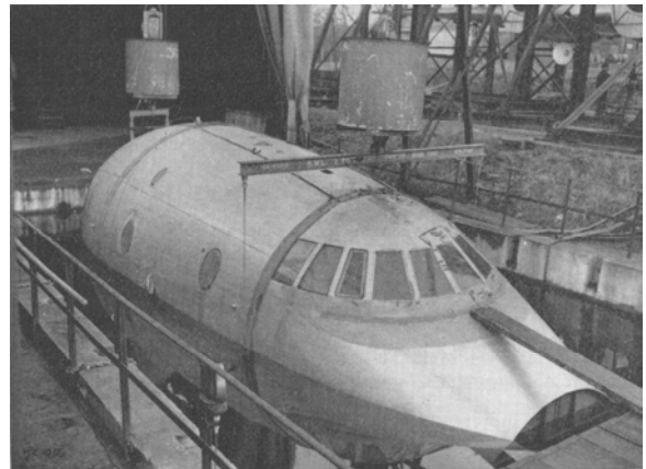
Figura 2.4- Ensaio de fadiga em uma estrutura (AMORIM 2003).
