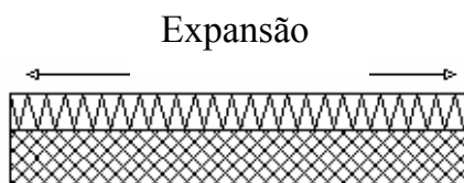
Figura 2.23 - Depósito com tensão de compressão (espiral comprimida) (STEIN B, 1996).
