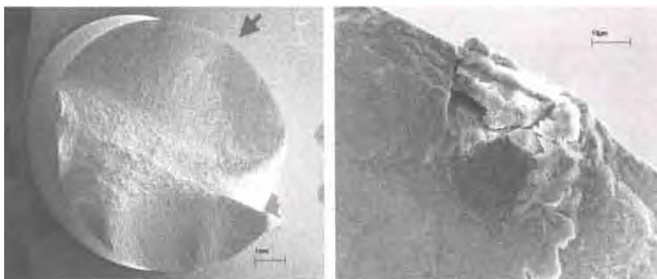
Figura 2.14 – Trinca nucleada a partir de uma inclusão superficial (AMORIM, 2003).
