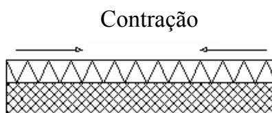
Figura 2.22 - Depósito com tensão de tração(espiral expandida) (STEIN B., 1996).
