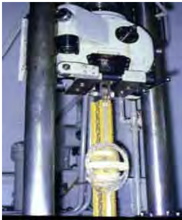
Figura 2.3 - Ensaio de fadiga em um componente aeronáutico (COSTA 2003)
