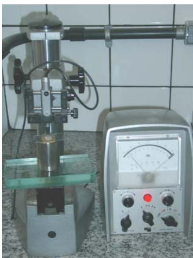
FIGURA 9 – Instrumento medidor de deslocamento efetuando a medida do corpo de prova.
