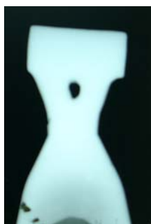
FIGURA. 3 – Raios-X da peça de Ti c.p. (RMI Company, Ohio, EUA).
