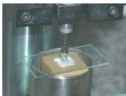
FIGURA 10 – Vista aproximada da ponta ativa do instrumento medidor de deslocamento.
