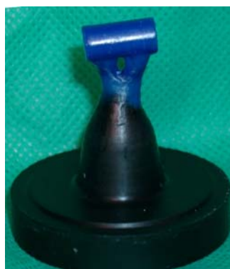
FIGURA. 1 – padrão de cera fixado à base formadora de cadinho.
