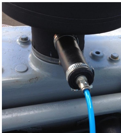
Figura 25. Adaptador para aferir a depressão no coletor de admissão.
