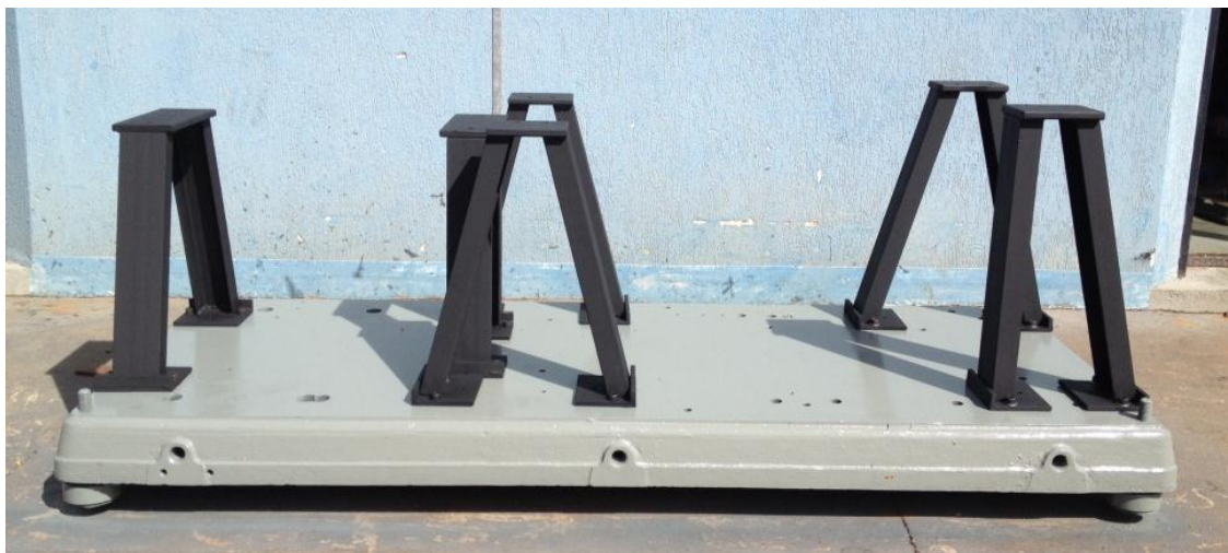
Figura 29. Pontos de sustentação do motor e do freio eletromagnético.
