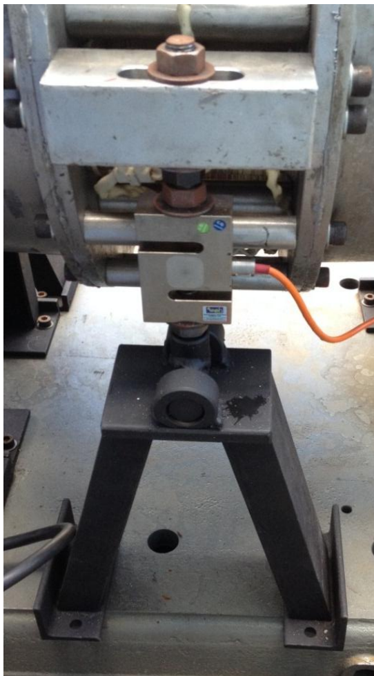
Figura 37. Célula de carga instalada.
