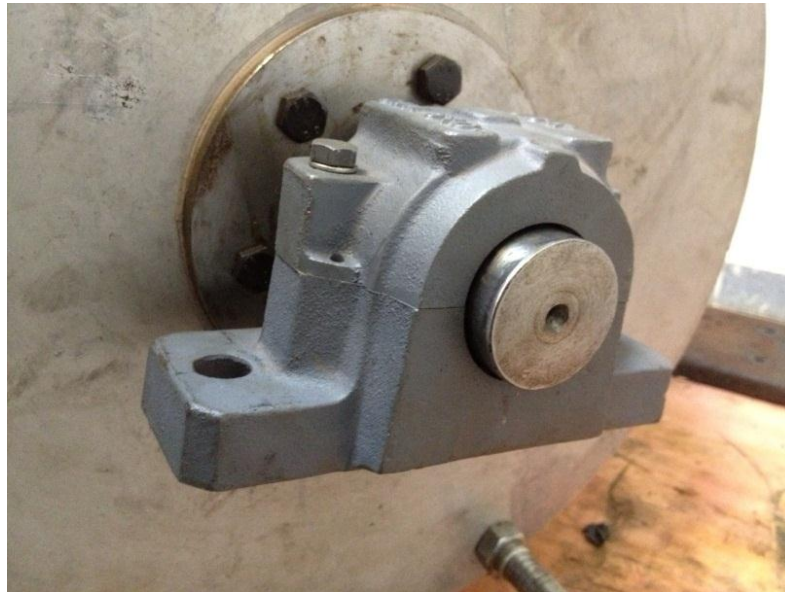
Figura 31. Mancal traseiro instalado.
