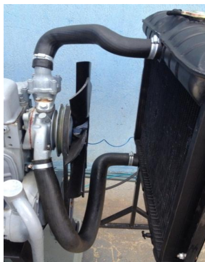
Figura 22. Mangueiras instaladas no radiador.
