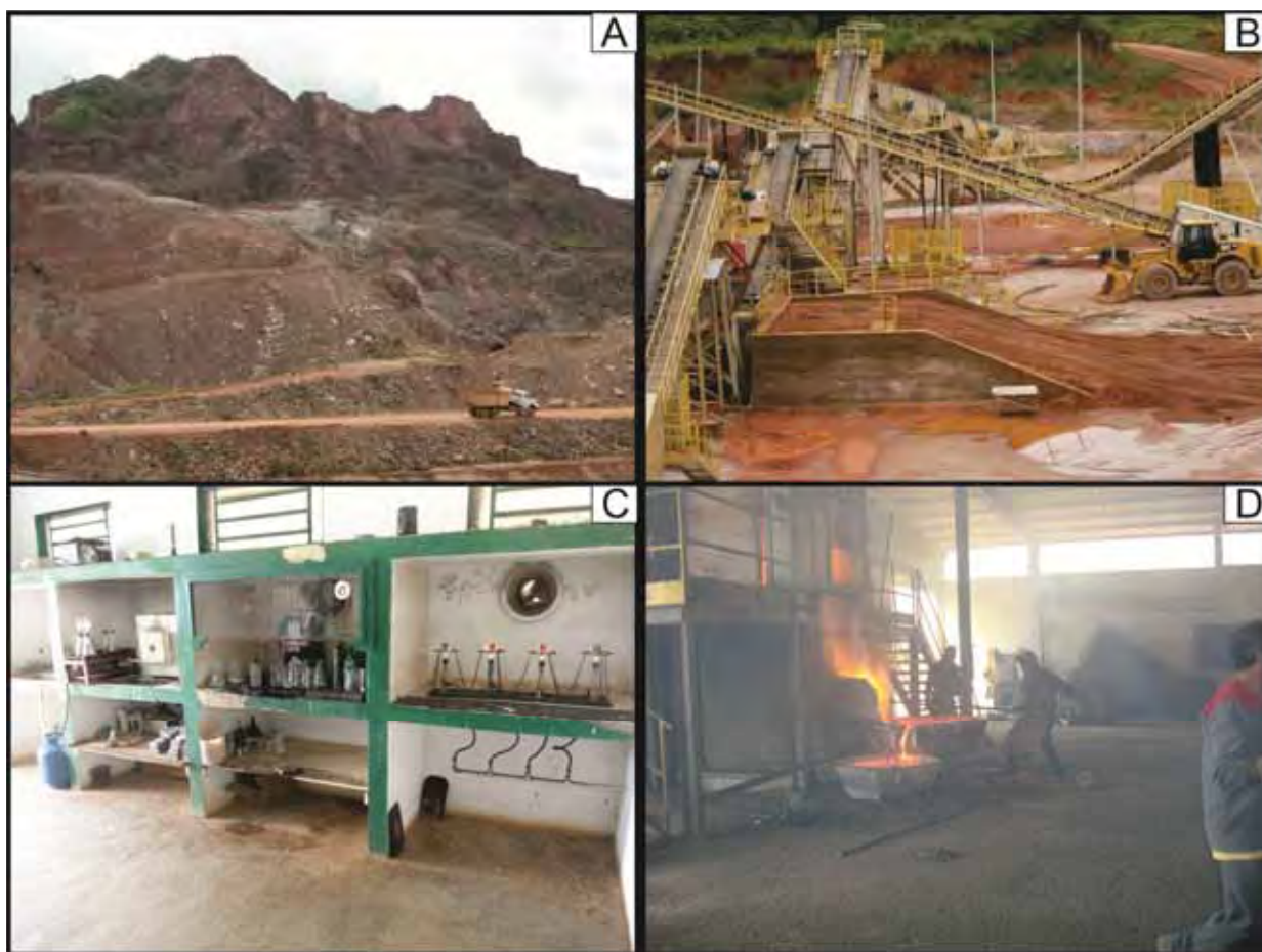
Mosaico 1: Mina Bom Futuro e instalações da COOPERSANTA. (A) Vista da porção Oeste do Morro Bom Futuro; (B) Britador instalado em 2012 para início da exploração do minério primário; (C) Laboratório de análise química da cooperativa; (D) Fundição da COOPERMETAL e processo de sangria, onde o minério fundido é separado das impurezas e levado para concentração do estanho.
