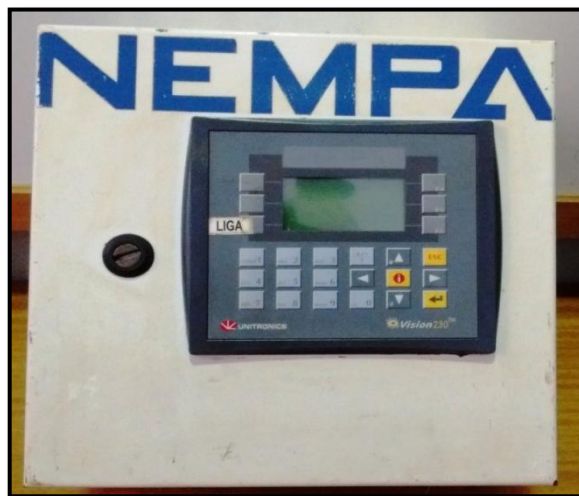
Figura 8. Controlador Lógico Programável (CLP) utilizado para coleta de dados
