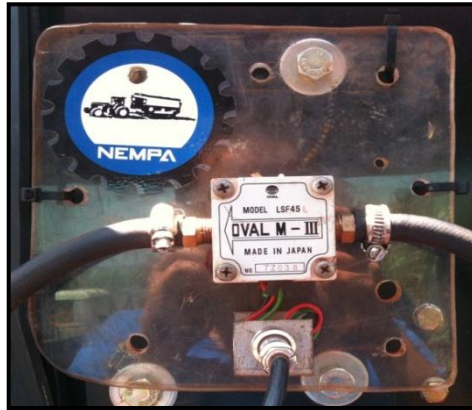
Figura 7. Fluxômetros instalados na entrada e no retorno do tanque da colhedora para determinação do consumo de combustível.
