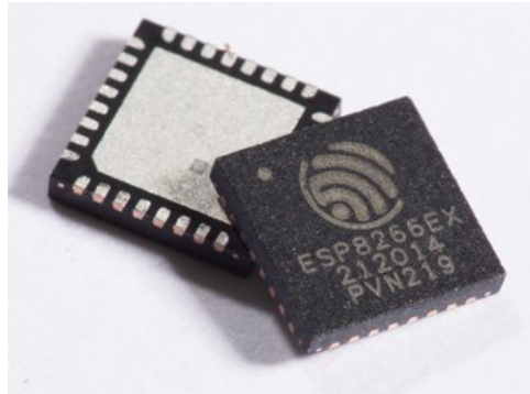
Figura 28 – ESP8266. Extraído de [14].
