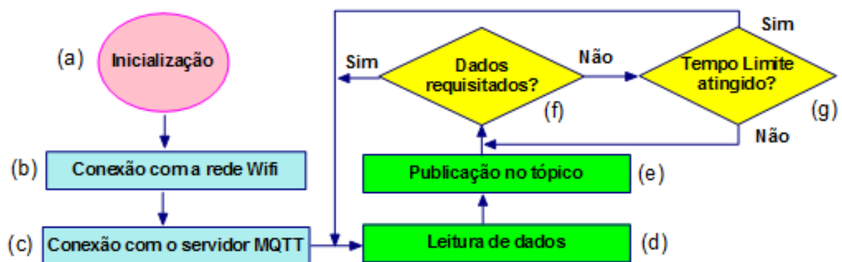
Figura 33 – Fluxograma do software embarcado nos dispositivos "Interruptor" e "Lâmpada". Elaborado pelo autor.
