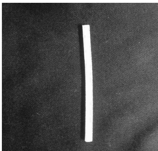
Figura 13. Filamento obtido a partir do processo de extrusão.
