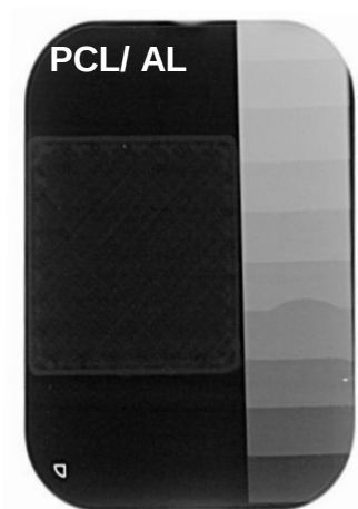
Figura 60. Foto radiográfica da \text{PCL}/\text{YVO}_4:\text{Yb}^{3+}:\text{Er}^{3+}-\text{Ap} .
