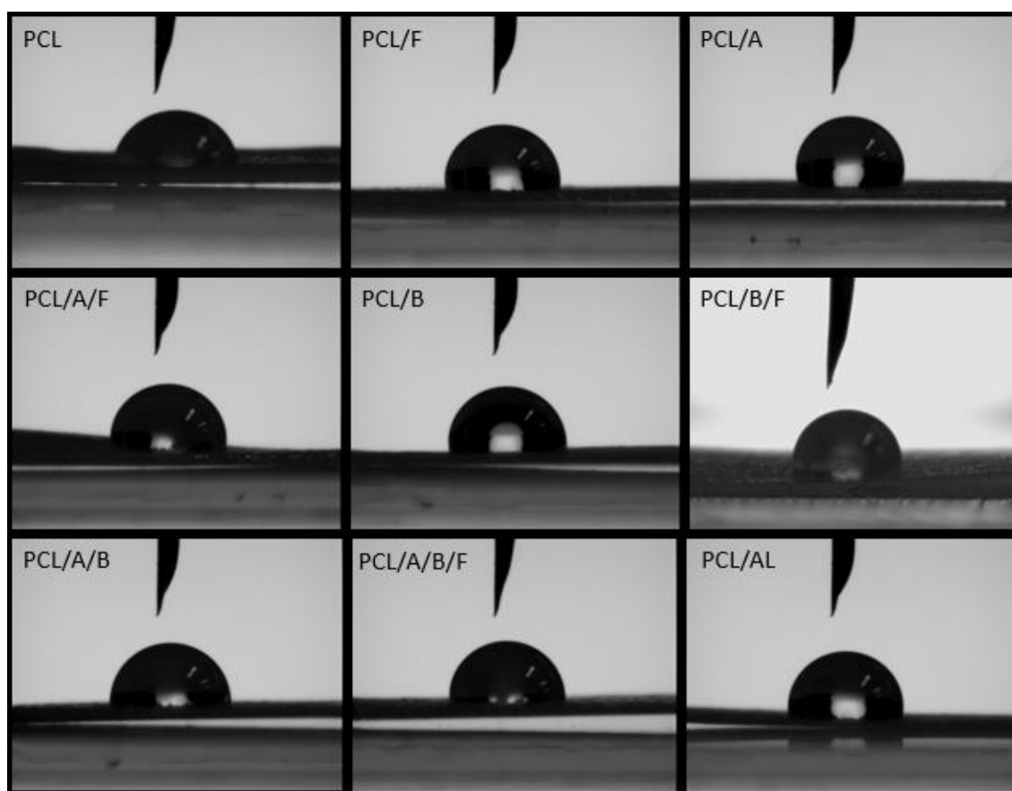
Figura 40. Medida de ângulo de contato em filmes de policaprolactona e dos 8 compósitos.
