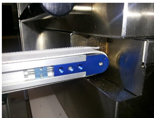
Figura 10. Extrusão dos compósitos na forma de filamentos padronizados.
